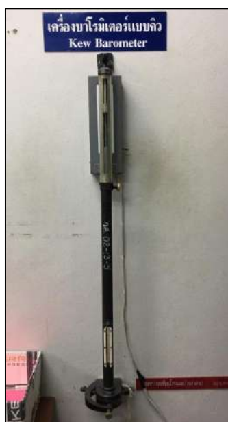
รูปที่ 2.7 เครื่องบาโรมิเตอร์แบบคิว (Kew Barometer) สำหรับใช้วัดความกดอากาศ
