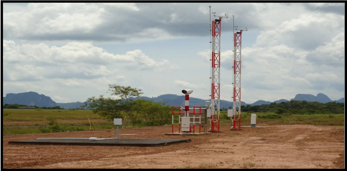
ภาพที่1 ภาพเครื่องมือตรวจอากาศอัตโนมัติระบบ AWOS
